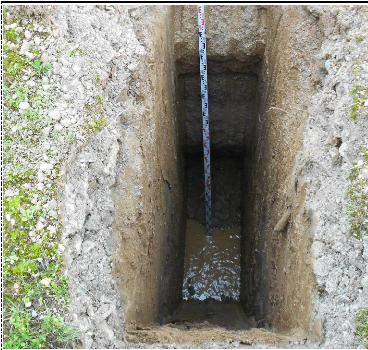
TRAFILAZIONE DI ACQUA D'INFILTRAZIONE AL CONTATTO FRA LE UNITÀ "R" ED "L" SI ACCUMULANO SUL FONDO DELLO SCAVO "T1"
