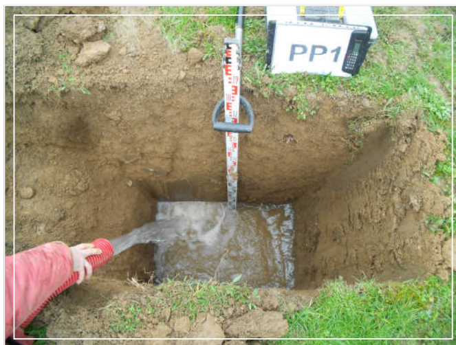
Fasi di riempimento del pozzetto per la realizzazione della prova "PP1"
