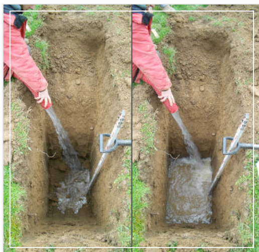
Fasi di riempimento del pozzetto per la realizzazione della prova "PP1"
